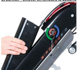
Une rotation de la clef dans le sens de la flèche bleue entraîne la libération de la batterie
