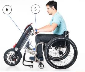
5) En tirant sur le guidon (5), approcher le Sirocco 2.0 du fauteuil jusqu'à ce que les tubes de potence (6) soient centrés dans les pinces.
